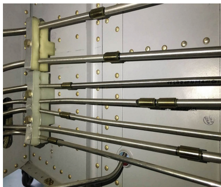
图3 运-12F飞机液压系统应用记忆合金接头形式
